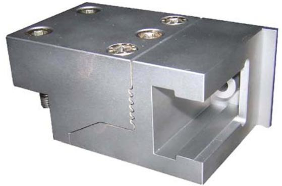
Il s'agit d'un bloc de serrage dont les dimensions hors tout sont égales à l'art. 01 – 4085 et avec les mêmes modes de réglage mais renversé de 90°. Permet la fixation de pièces de toutes hauteurs et toutes largeurs jusqu'à 70 mm par le biais des mâchoires fournies dans le kit série 40 ou 60.
